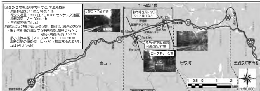
国道 340 号線押角峠現道区間の課題整理
